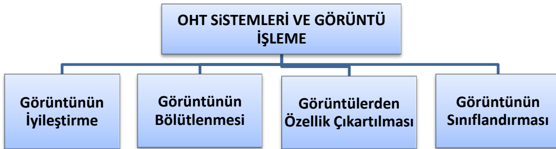
Şekil 3.3 OHT sistemlerinde görüntü işleme blokları
