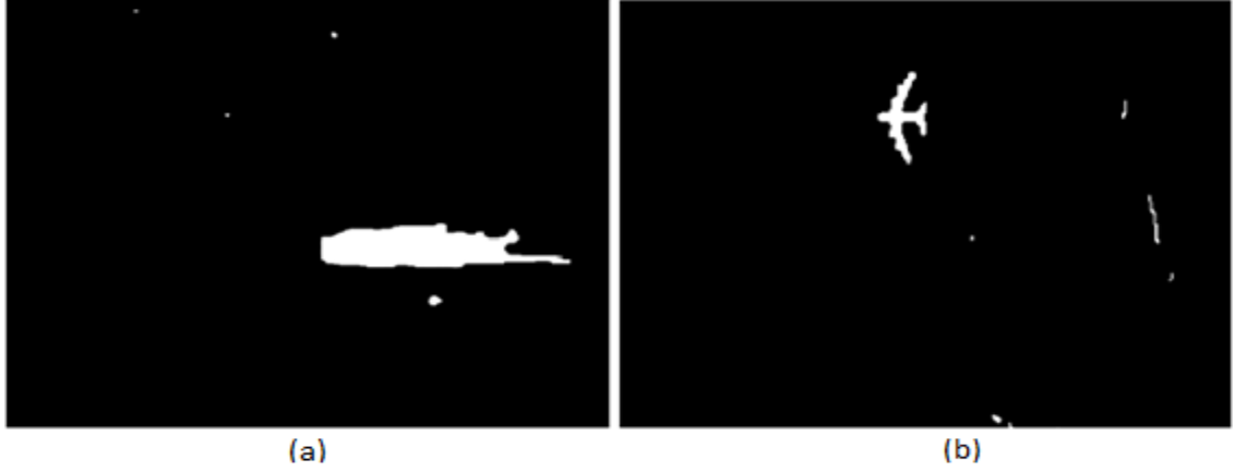
Şekil 4.32 Medyan filtre uygulanması (1. ve 2. görüntüler) (a) 1. Görüntü için medyan filtre uygulanması (b) 2. Görüntü için medyan filtre uygulanması
