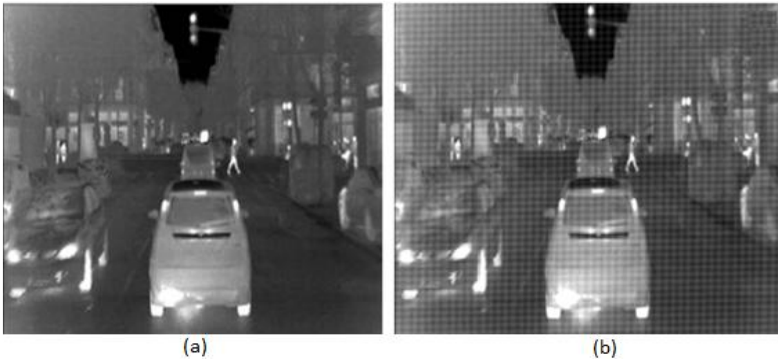
Şekil 4.5 Periyodik gürültü (a) 1. Görüntü (b) 1.Görüntünün üzerine periyodik gürültü eklenmiş durumu
