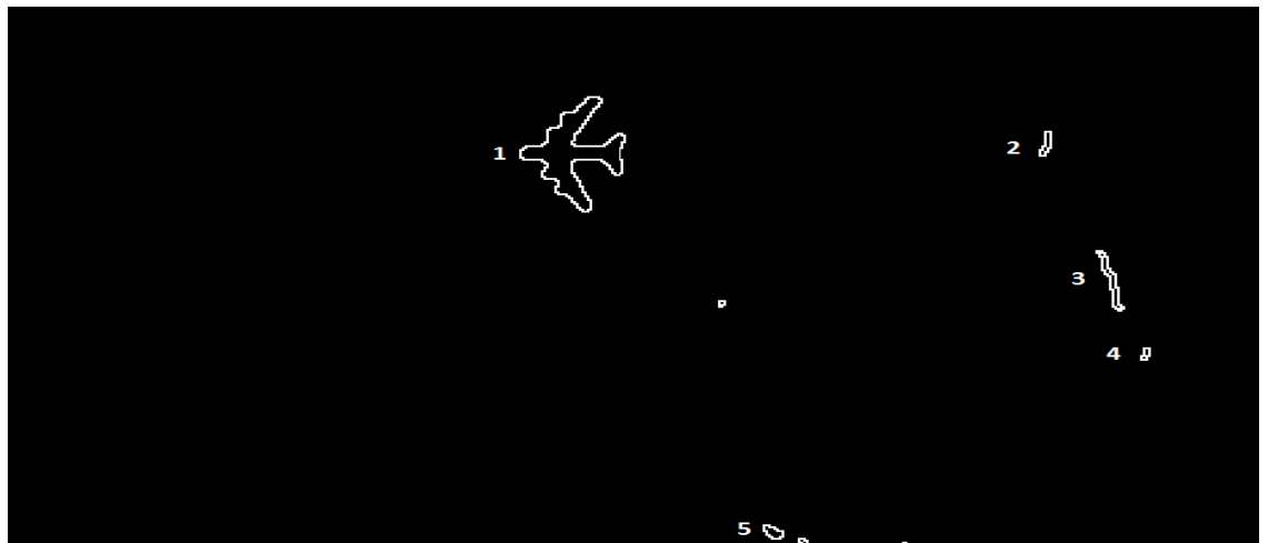
Şekil 4.39 Sınırlarının tek piksel halinde elde edilmesi 2. görüntü
