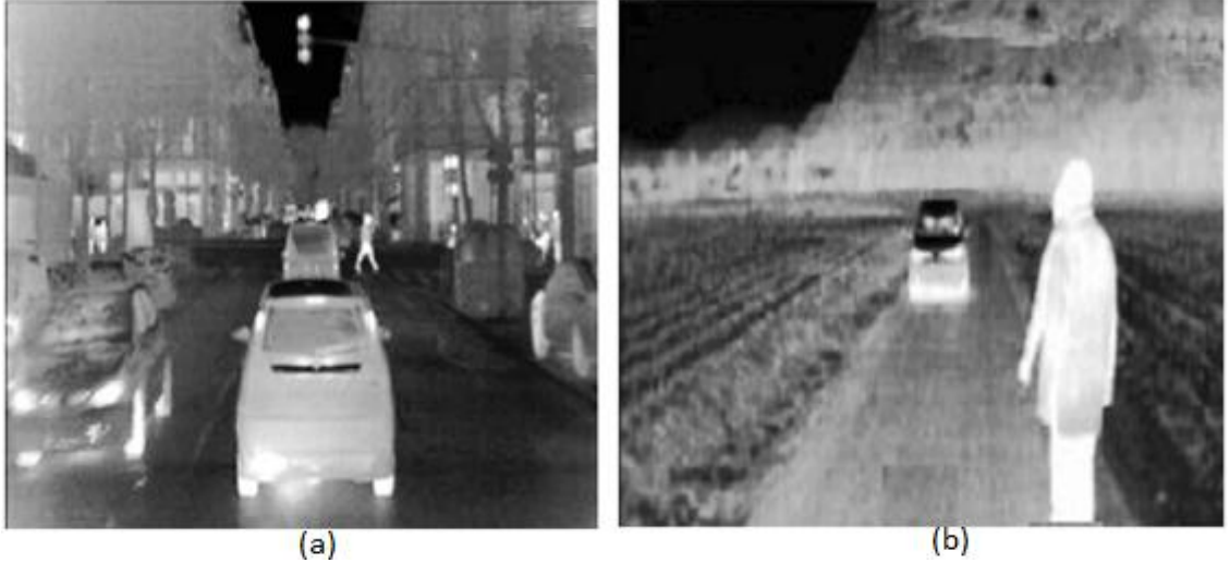
Şekil 4.11 Orijinal görüntünün eklenmesi (3. ve 4. görüntü) (a) 3.Görüntü + histogramı dengelenmiş görüntü (b) 4.Görüntü + histogramı dengelenmiş görüntü
