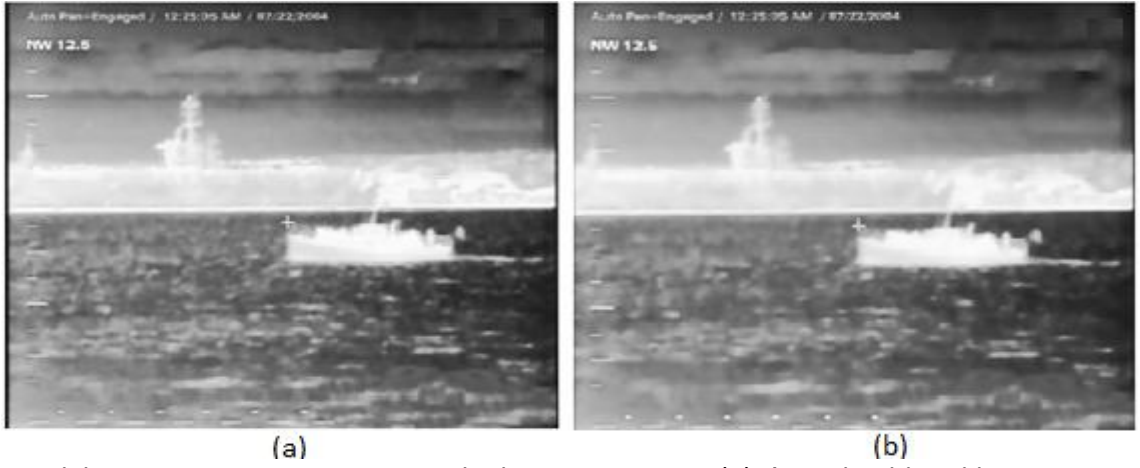
Şekil 4.14 1. Görüntü için izotropik olmayan yayılım (a) i=12 ile elde edilen sonuç (b) i=24 ile elde edilen sonuç
