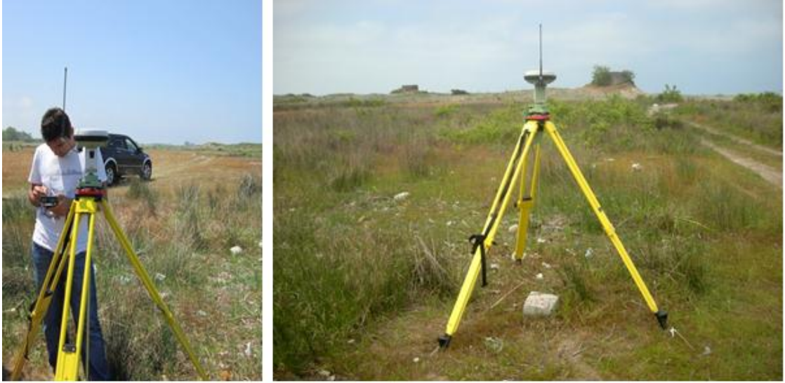
Şekil 3.32 Leica sabit GNSS referans istasyonu; 1.poligon noktası
