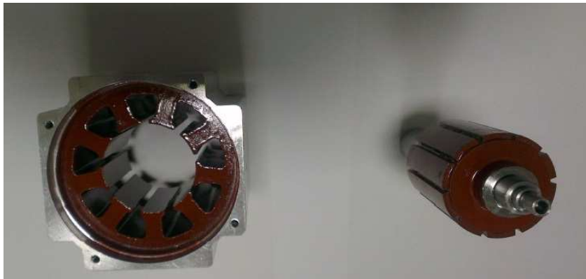
Şekil 8.6 YMK malzemeli kesirli oluklu sürekli mıknatıslı senkron makinanın stator ve rotorunun üretilmiş hali
