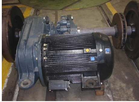
Şekil 2.7 Motorlu boji tekerlek seti [151]
