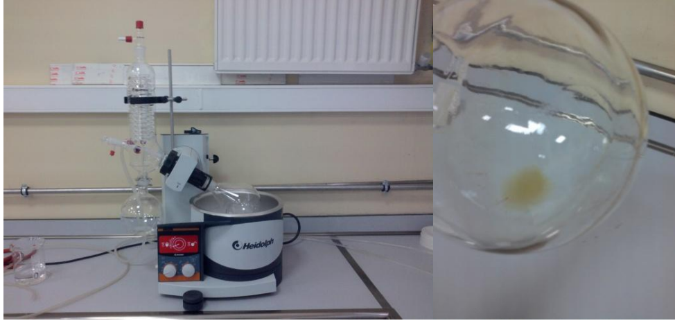
Şekil 4.8 Döner buharlaştırıcı ve elde edilen ekstrat
