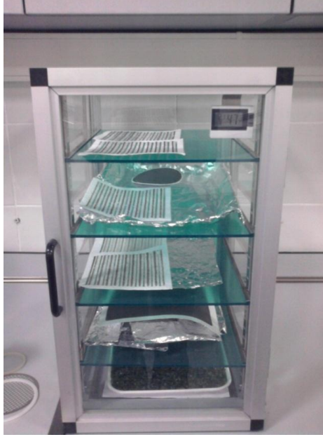
Şekil 4.6 Örnekleyciden toplanan filtrelerin şartlandırılması
