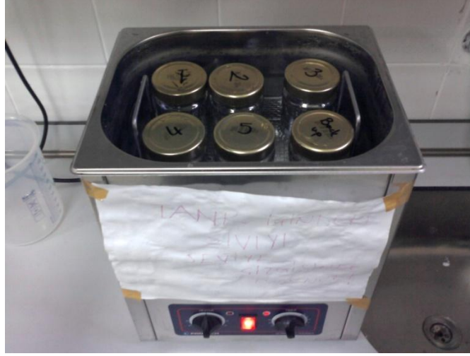
Şekil 4.7 Ultrasonik banyo düzeneği içinde filtrelerin ekstrakte edilmesi
