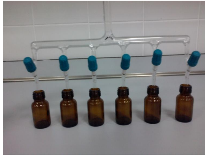
Şekil 4.9 Azot ile solvent uçurma düzeneği
