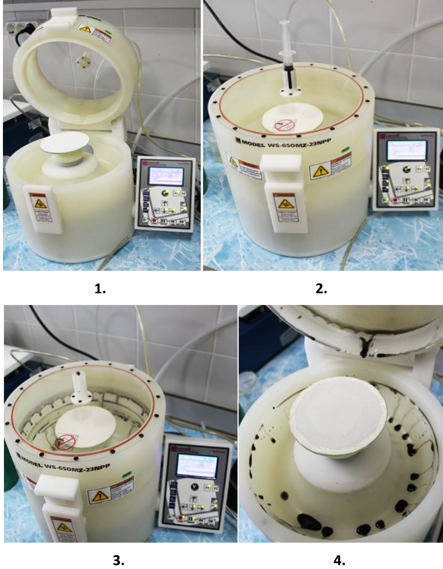
Şekil 4.8 Döndürmeli kaplama yönteminin adımları
