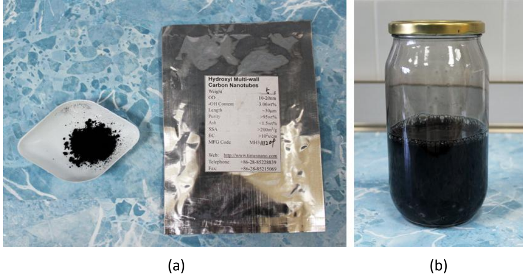
Şekil 4.5 MWCNT-OH çözeltisinin hazırlanışı: (a) MWCNT-OH nanotozu (b) %0,08 MWCNT-OH/0,8 CS (w/v) çözeltisi
