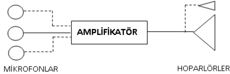
Şekil 3.16 Tek kanallı seslendirme sisteminin temel bileşenleri [3]
