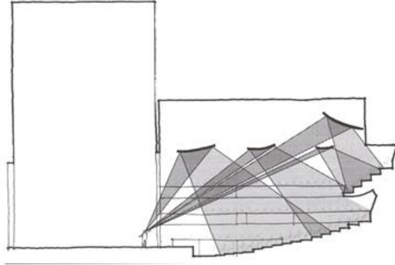
Şekil 3.11 Prensip tavan panelleri tasarımı ve yansıma örgüsü [11]
