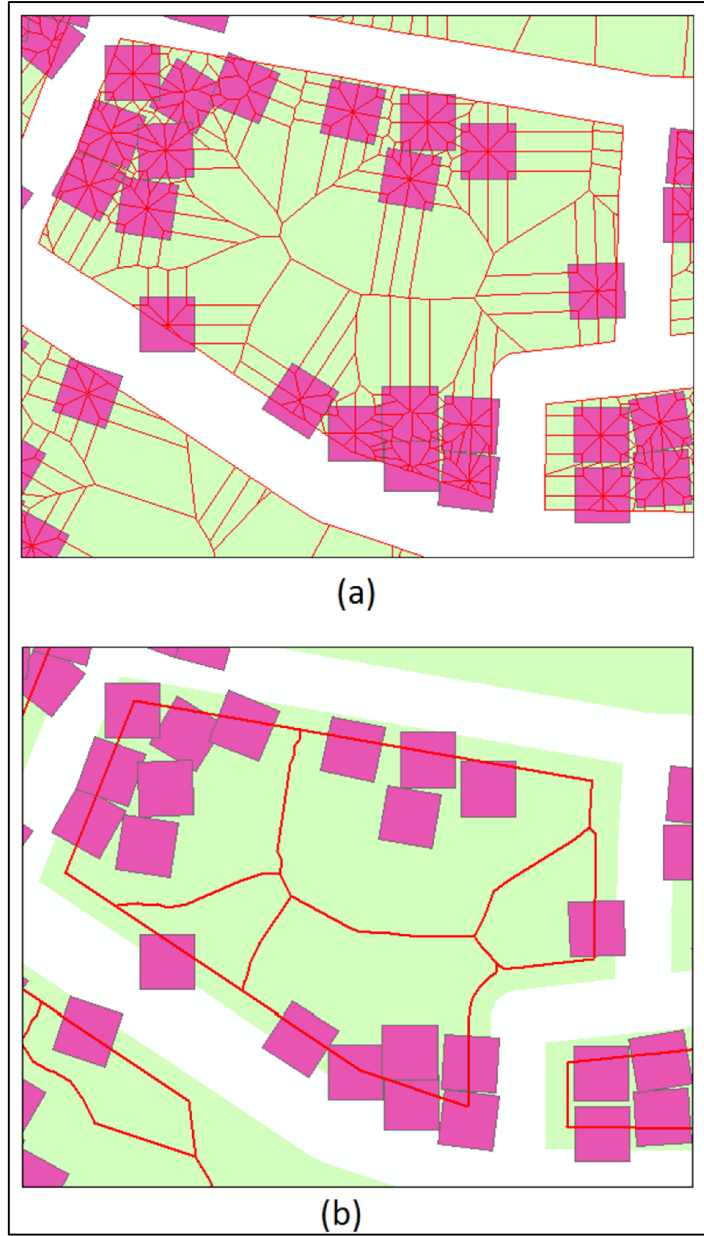
Şekil 4. 20 (a) Kırpılmış Voronoi çokgenleri (b) Temizleme ve düzenleme sonrası Voronoi bölgesi
