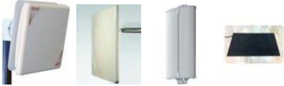
Şekil 3.3 Farklı tasarımlarda anten örnekleri [14]
