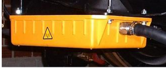
Şekil 3.7 M2 İstanbul Metrosu'nda kullanılan balis anteni
