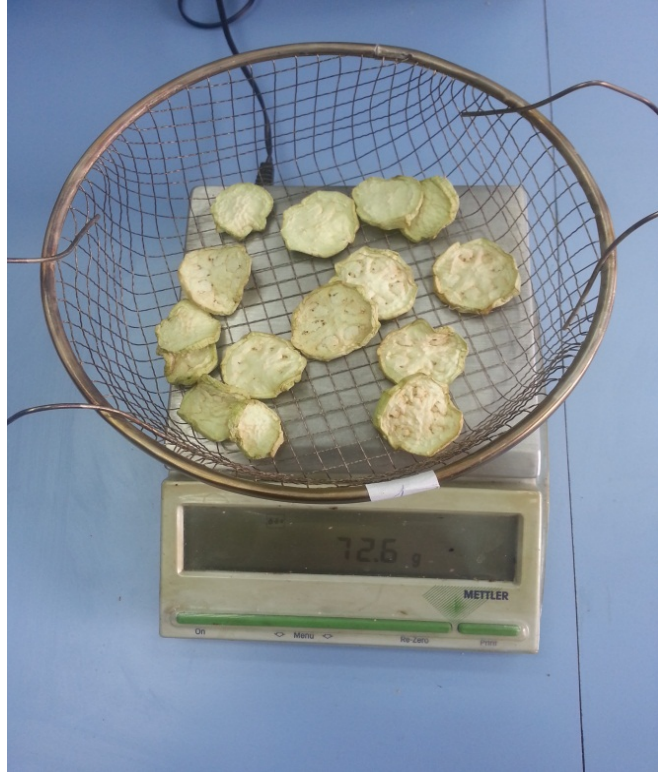
Şekil 5.7 Kurutma sırasında yapılan tartım işlemi
