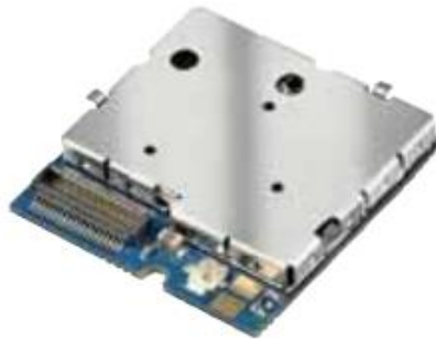
Şekil 3. 14 HiLo SAGEM GSM/GPRS haberleşme modülü
