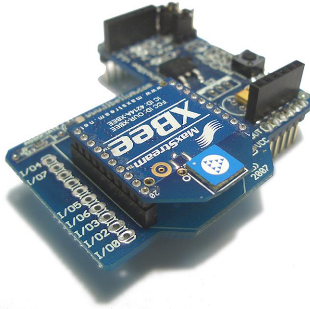
Şekil 3. 9 Arduino geliştirme kartı için geliştirilen XBee haberleşme modülü
