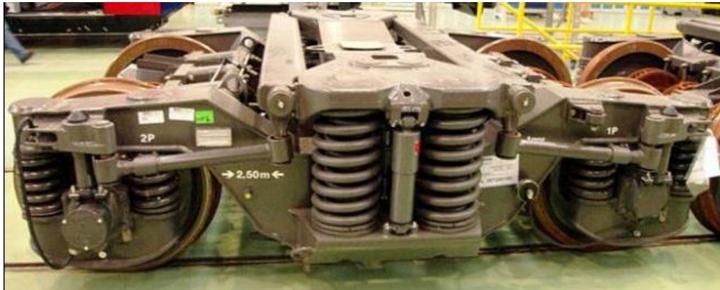
Şekil 3.2 İki akslı konvansiyonel yolcu vagonu bojisi
