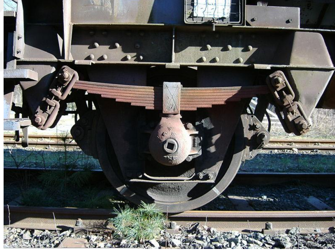
Şekil 3.1 Tek akslı yük vagonu bojisi
