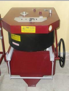
Çizelge 4.4 Çalışmalarda kullanılan harç karma makinesi ve teknik bilgileri
