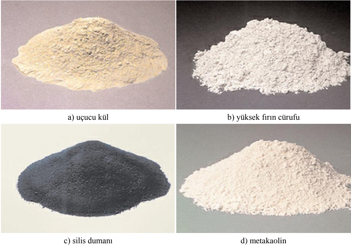
Şekil 2.25 Endüstriyel puzolanlardan örnekler [57]
