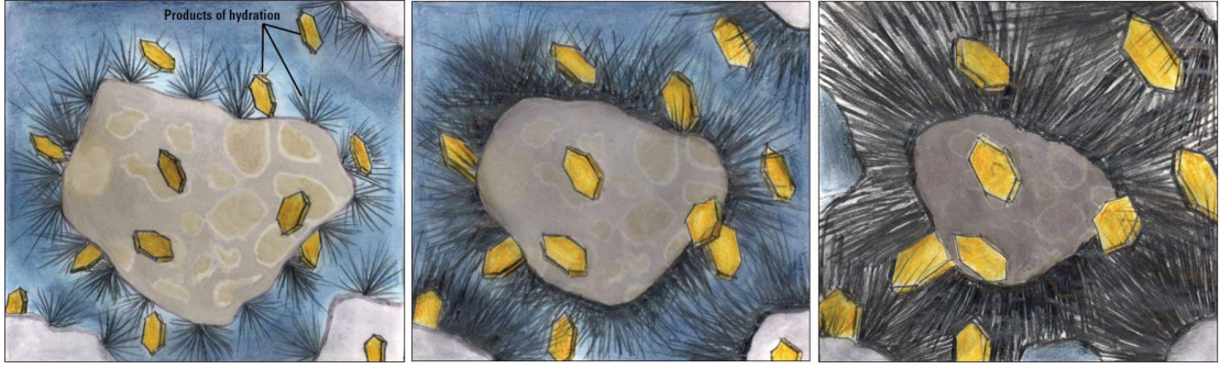
Şekil 2.16 Hidratasyon süreçleri boyunca çimento hamurundaki zamansal değişim [61]
