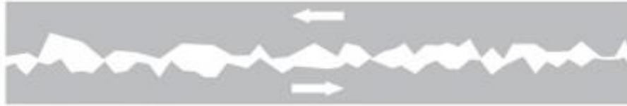
Şekil 2.6 Kuru sürtünme mekanizması
