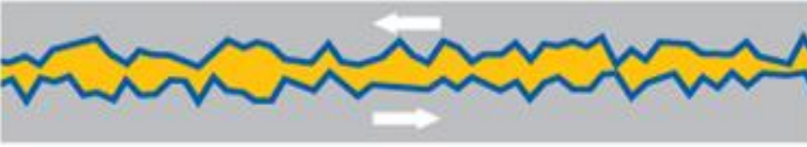
Şekil 2.8 Yarı sıvı sürtünme mekanizması
