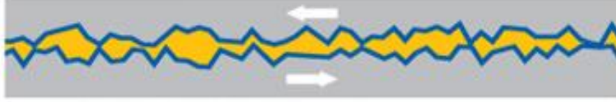
Şekil 2.7 Sınır sürtünme mekanizması
