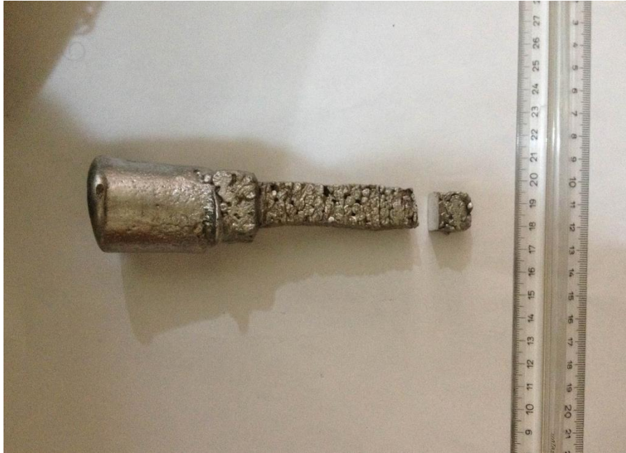
Şekil 7. 10 Görüntü ve mikroyapı analizi için numuneden alınan parça
