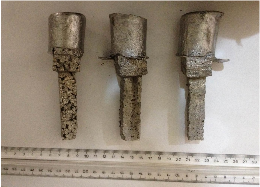
Şekil 7. 9 780 °C'de yapılan dökümde elde edilen edilen sırasıyla 26,2 kg/ m 3 ,16.3 kg/ m 3 , 8,4 kg/ m 3 yoğunluğa sahip parçalar
