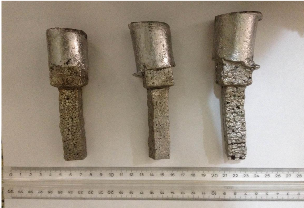
Şekil 7. 7 720 °C'de yapılan dökümde elde edilen sırasıyla 26,2 kg/ m 3 , 16.3 kg/ m 3 , 8,4 kg/ m 3 yoğunluğa sahip parçalar
