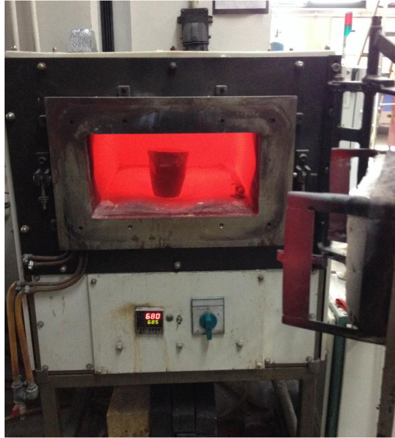
Şekil 7. 5 Ergitme Fırını içerisinde ergitme işlemi
