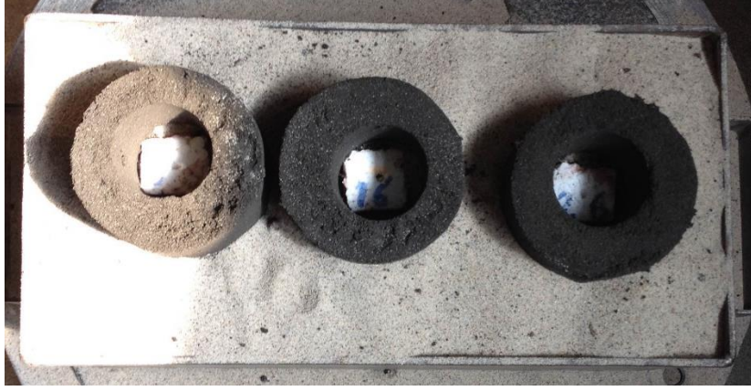
Şekil 7. 3 Modellerin Derece İçerisinde Serbest Kumla Kalıplanması
