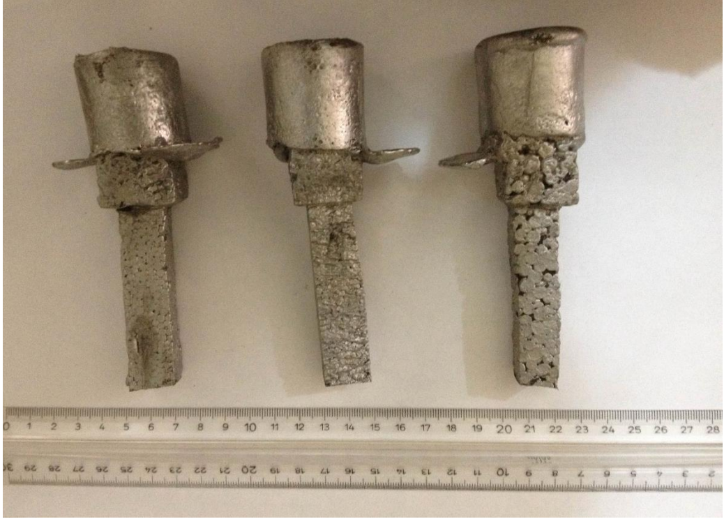
Şekil 7. 8 760 °C'de yapılan dökümde elde edilen edilen sırasıyla 26,2 kg/ m 3 ,16.3 kg/ m 3 , 8,4 kg/ m 3 yoğunluğa sahip parçalar
