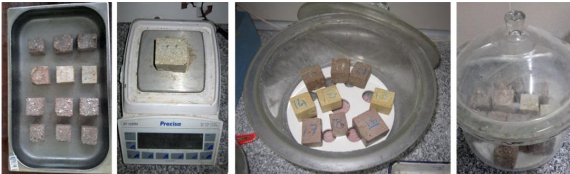
Şekil 5. 8 Kuruma hızı tayini deneyi aşamaları
