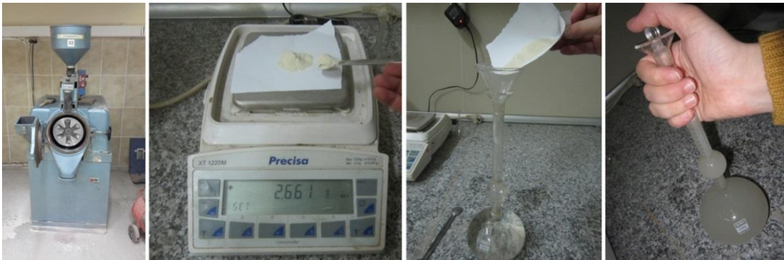
Şekil 5. 6 Gerçek yoğunluk deneyi aşamaları
