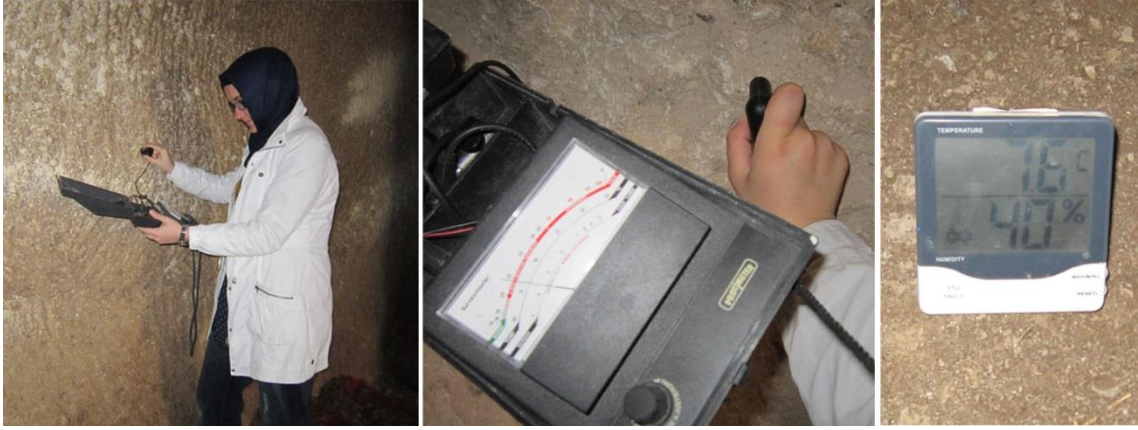
Şekil 5. 1 Çalışma alanlarında nem ve sıcaklık ölçümleri
