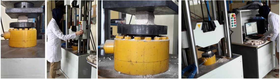
Şekil 5. 10 Basınç dayanımı tayini deneyi aşamaları
