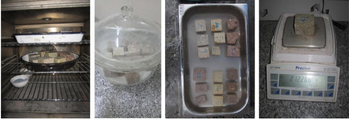
Şekil 5. 5 Görünür yoğunluk deneyi aşamaları
