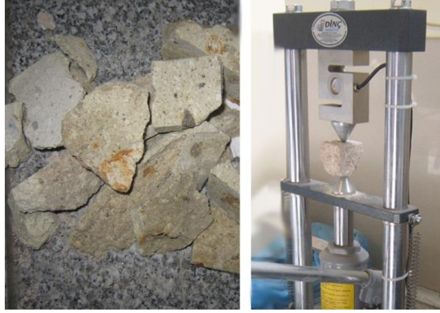
Şekil 5. 11 Nokta yükleme deneyi aşamaları
