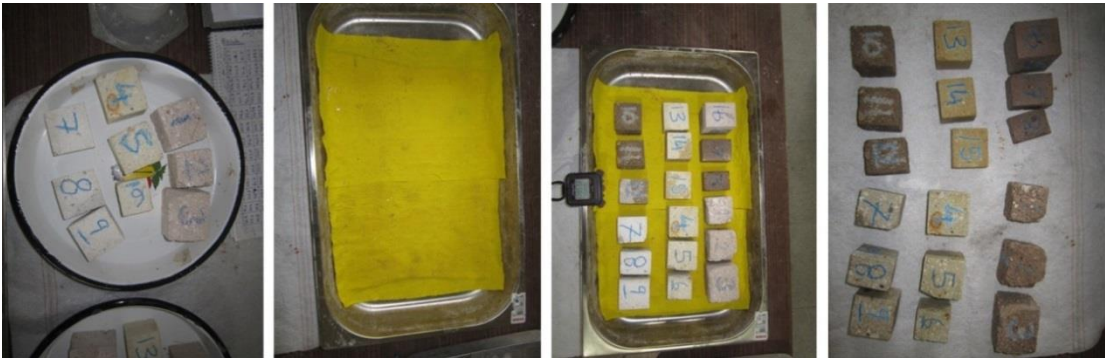
Şekil 5. 7 Kılcal su emme miktarı tayini deneyi aşamaları
