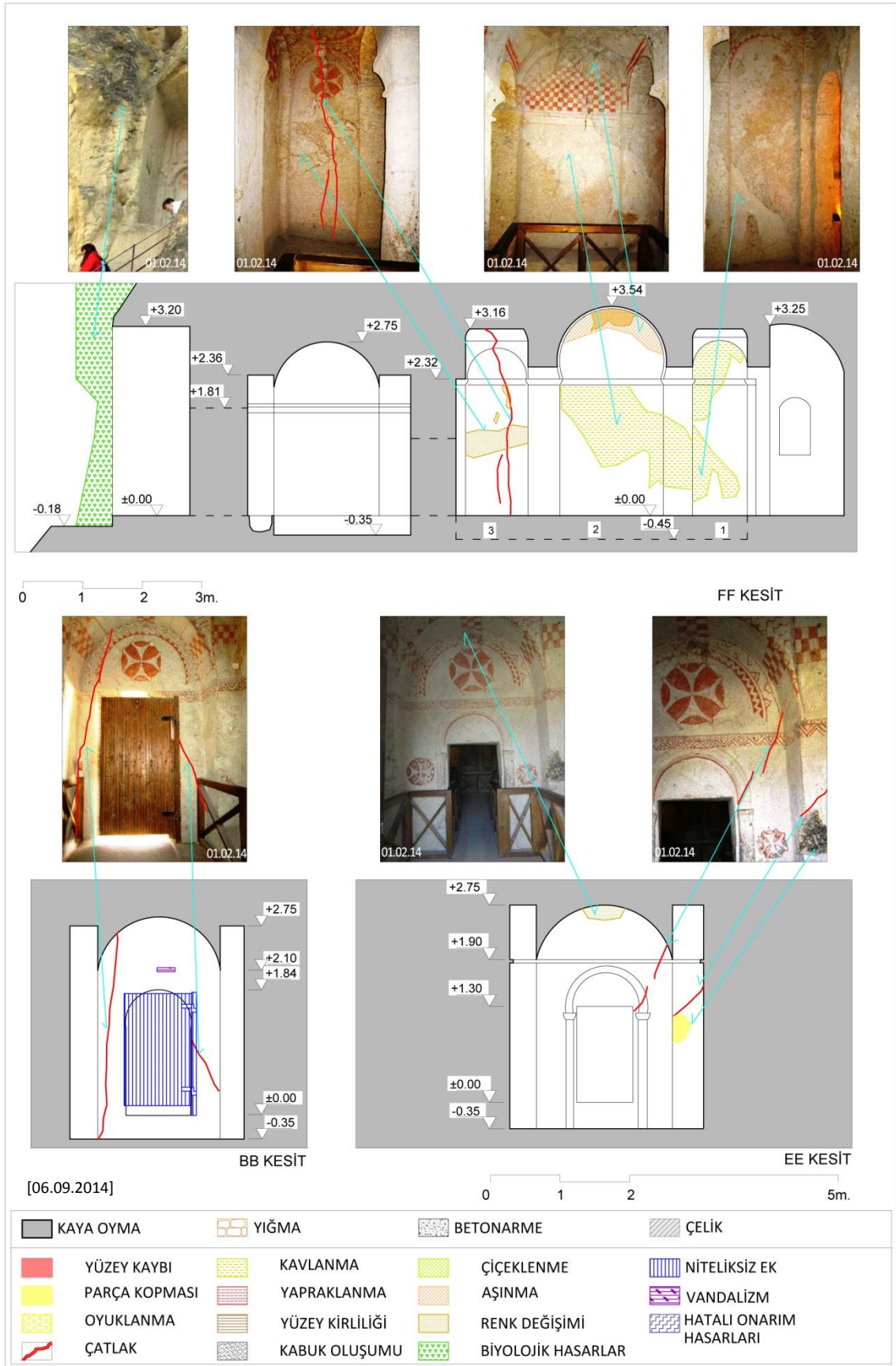
Şekil 4. 13 Malta Haçlı Kilise hasarları (FF, BB ve EE kesitleri)
