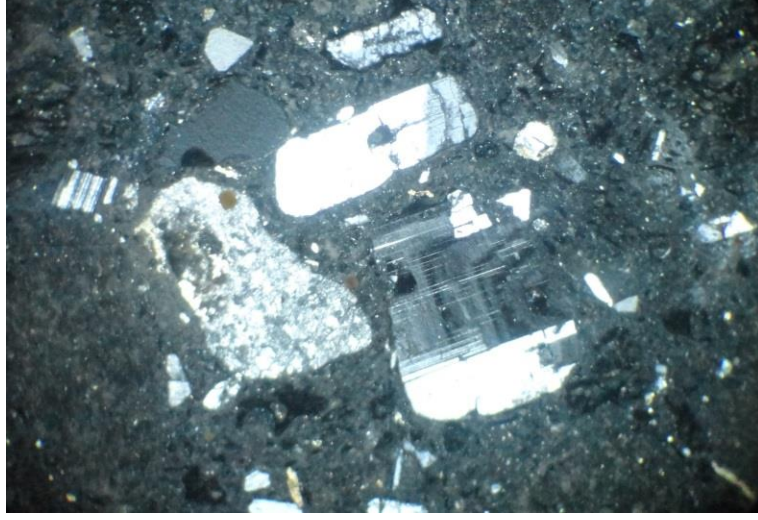
Şekil 5. 22 OK-15 kayacı mikroskop görünümü (Çift nikol, kesit boyu 4 mm) [92]
