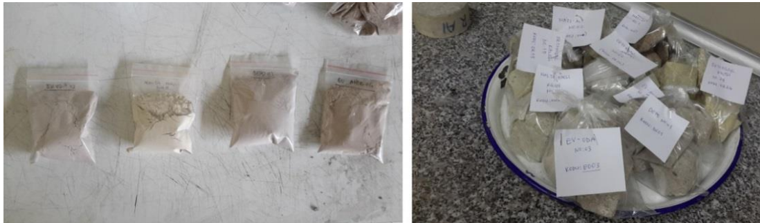
Şekil 5. 12 Kimyasal-petrografik ve minerolojik özellik tayini için hazırlanan numuneler
