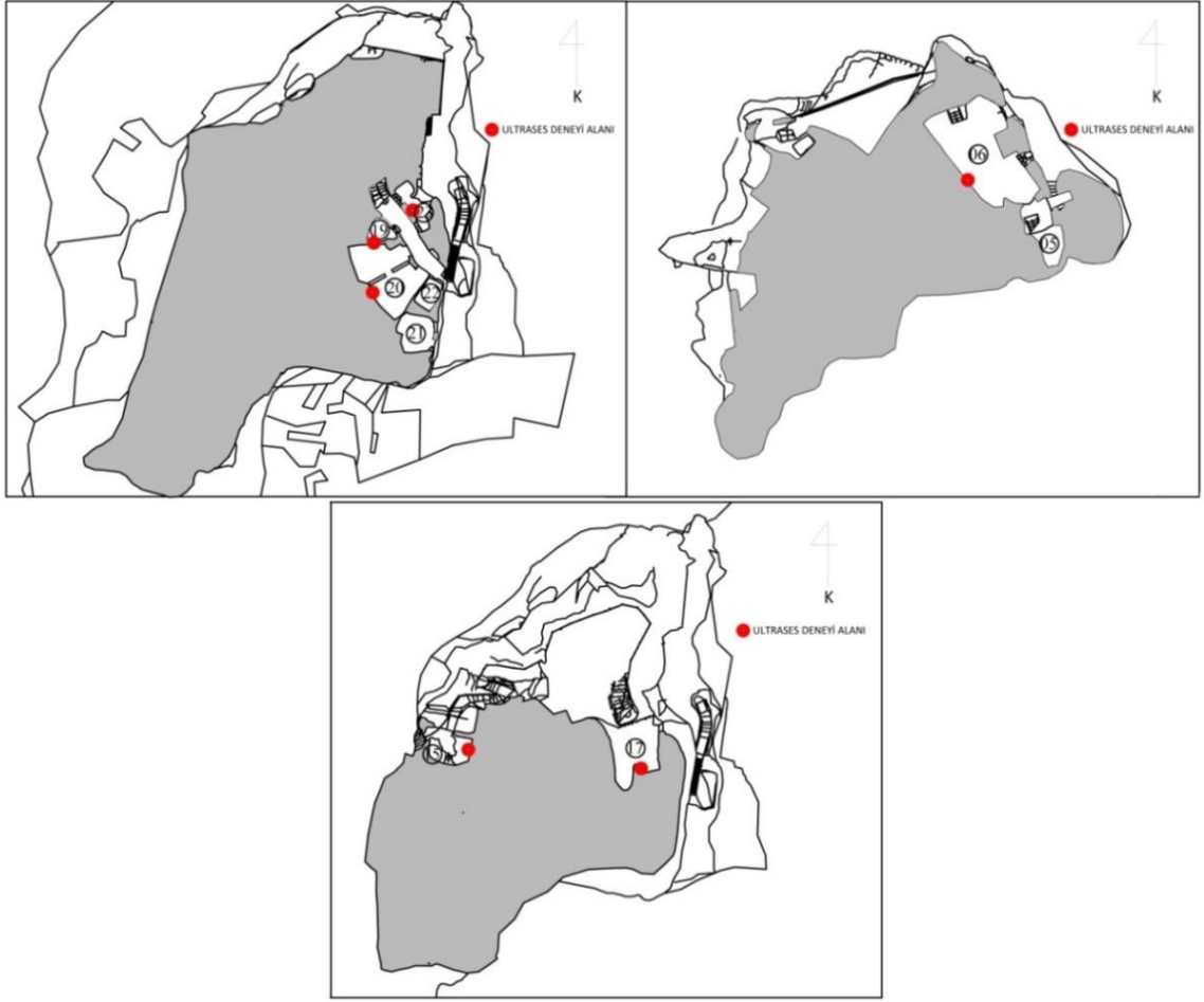
Şekil 5. 19 Ortahisar Kalesi ultrases geçiş hızı ölçümü alanları
