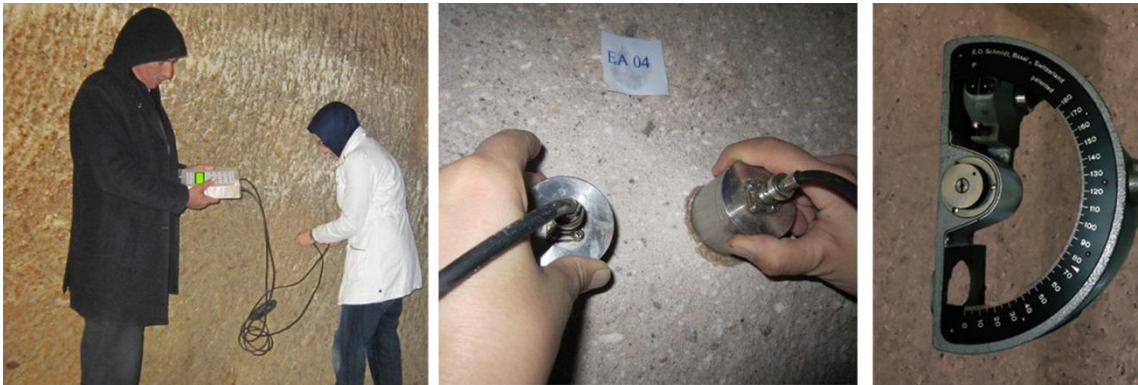
Şekil 5. 2 Çalışma alanlarında ultrases geçiş hızı ölçümü
