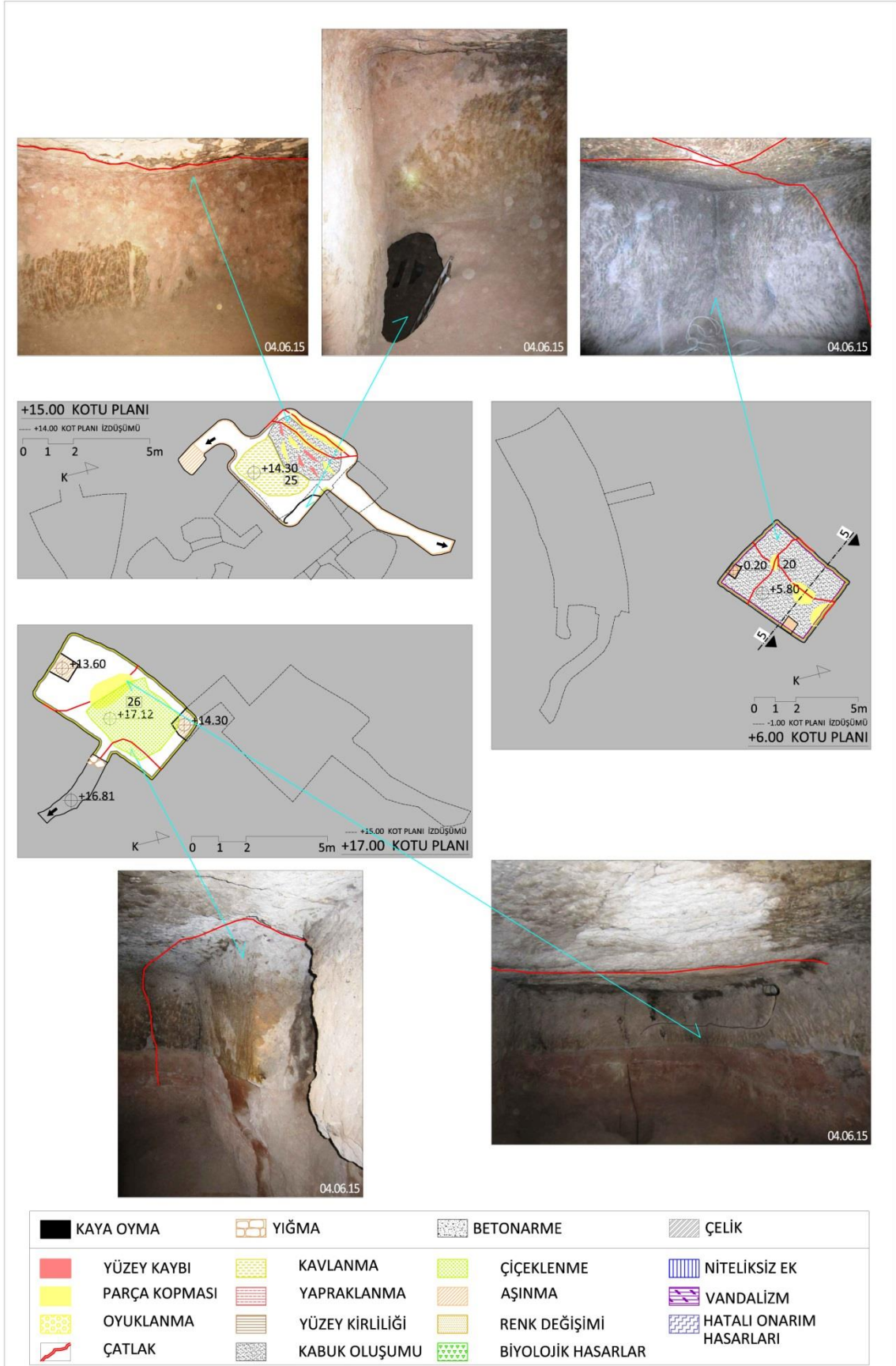
Şekil 4. 32 Mazı Yeraltı Şehri 20, 25 ve 26 no.lu mekânların hasarları
