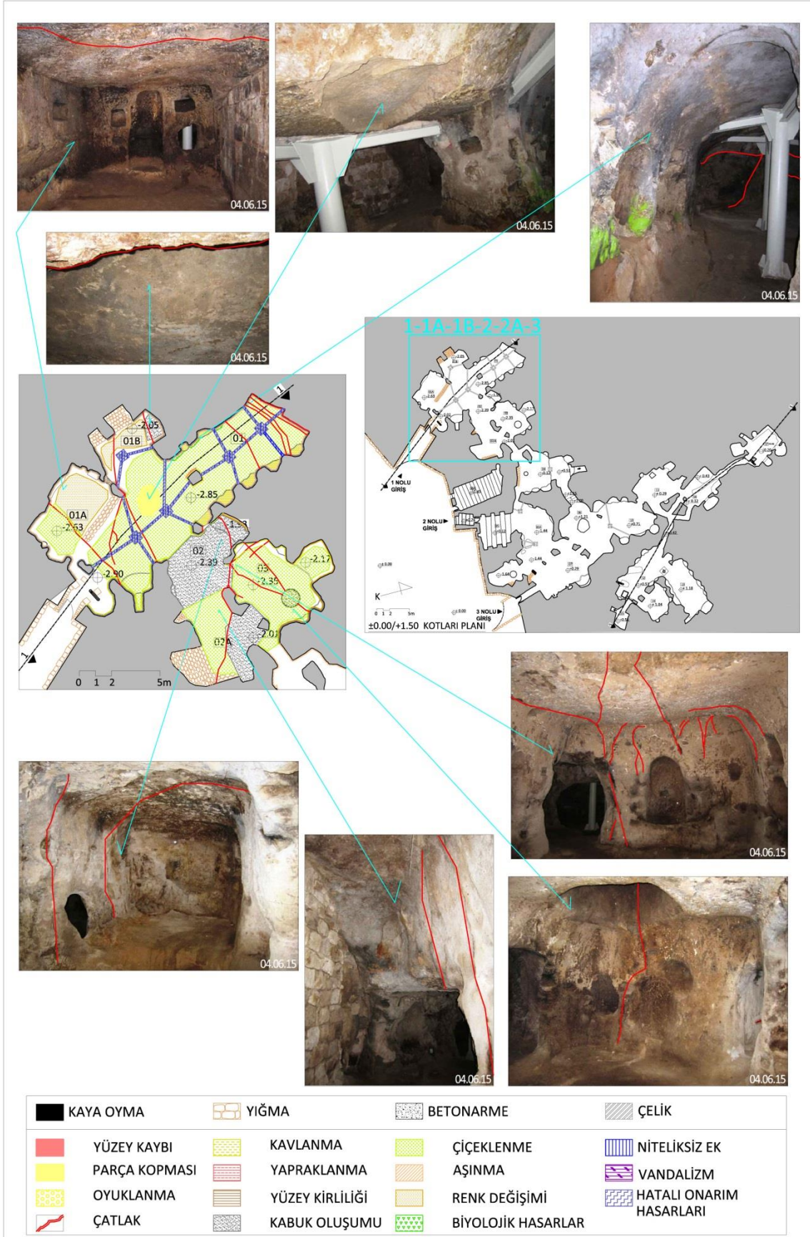
Şekil 4. 26 Mazı Yeraltı Şehri 1, 1A, 1B, 2, 2A ve 3 no.lu mekânların hasarları
