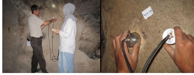
Şekil 5. 28 Mazı Yeraltı Şehri ultrases geçiş hızı ölçümü
