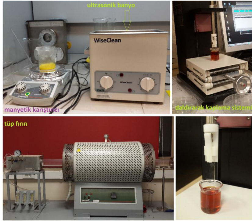
Şekil 2.2.1 İnce film üretim sistemi.
