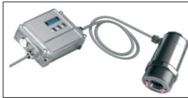
Şekil 3.4 Deneilerde kullanılan temassız sıcaklık ölçüm sistemi
