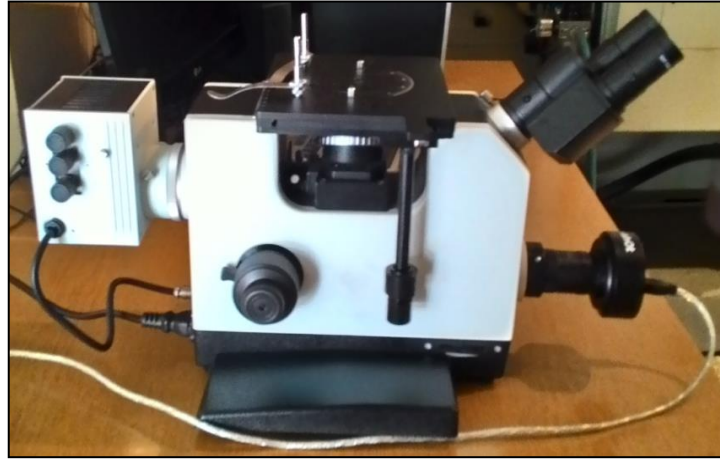
Şekil 3.5 Deneylerde kullanılan trinoküler metal mikroskop
