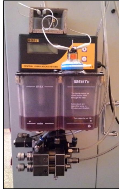
Şekil 3.3 Deneylerde kullanılan MQL sistemi
