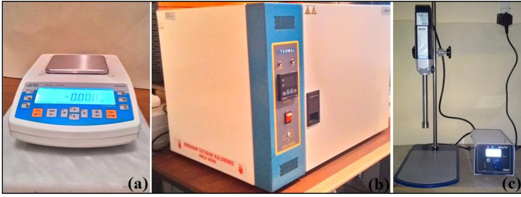
Şekil 3.8 Deneylerde kullanılan a) hassas terazi, b) etüv, c) dijital homojenizatör
