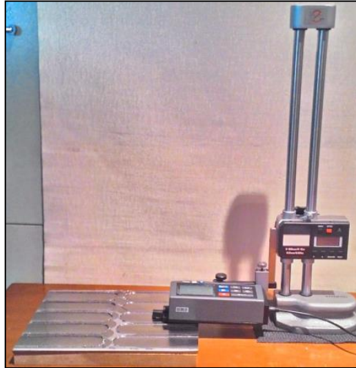
Şekil 3.7 Deneylerde kullanılan yüzey pürüzlülük cihazı
