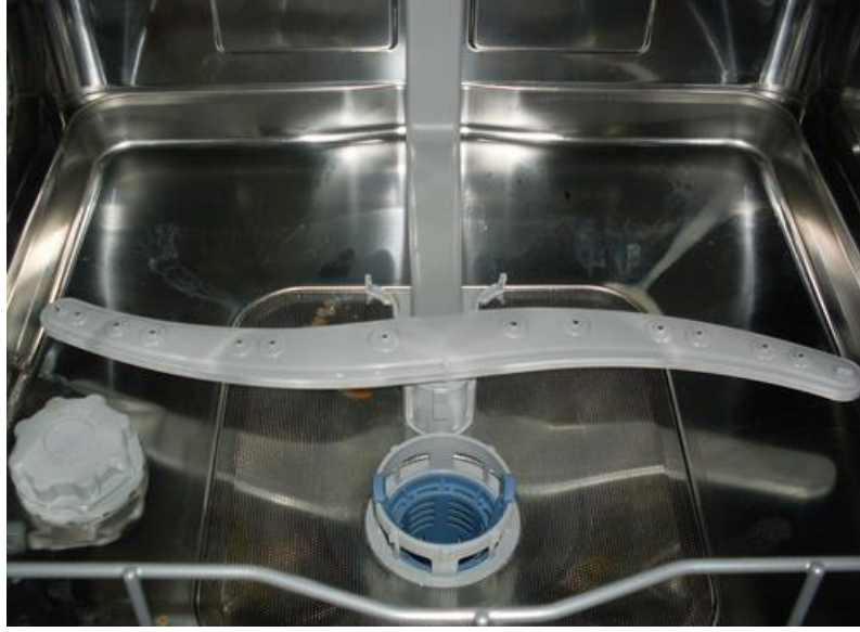
Şekil 2. 28 Yıkayıcılarda pervanenin konumu [14]
