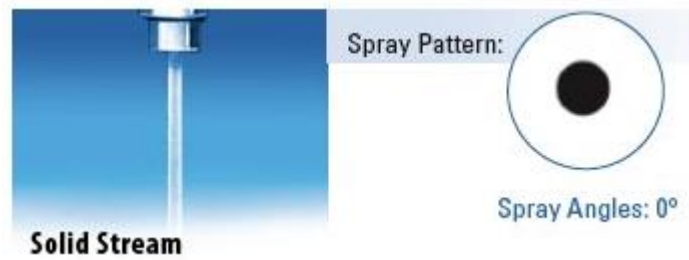
Şekil 2. 22 Noktasal püskürtme türü [11]
