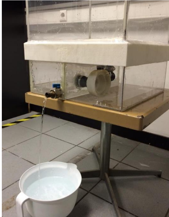
Şekil 4. 10 Pompa ve küresel vananın montajı
