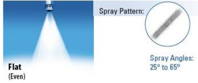
Şekil 2. 20 Yassı püskürtme (eşit bitişli) türü [11]
