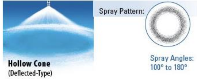
Şekil 2. 15 İçi boş koni (şaşırtmalı tip) püskürtme türü [11]
