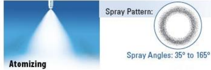
Şekil 2. 23 Atomize püskürtme türü [11]
