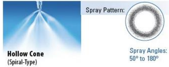
Şekil 2. 16 İçi boş koni (spiral tip) püskürtme türü [11]
