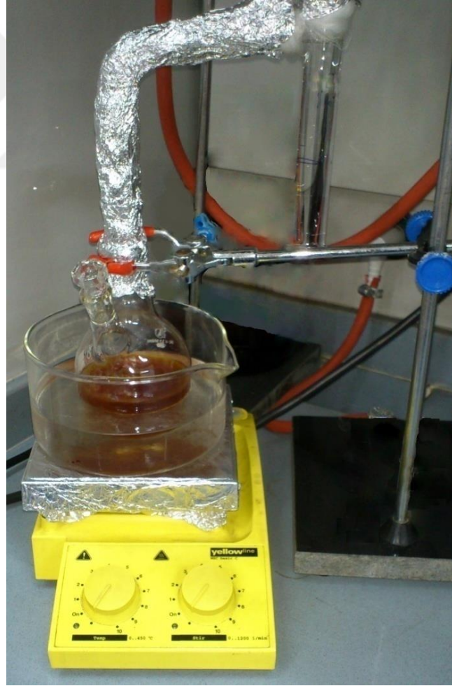
Şekil 5.9 Yan kollu balonda \text{Mn}(\text{OAc})_3 reaksiyonu
