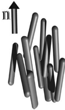
Şekil 2. 3 Dikey n vektörü doğrultusunda yönelen nematik faz (Lagerwall ve Scalia [48])
