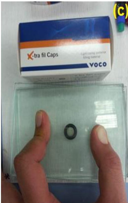
Şekil 5. 3 Dental kompozit numunelerin hazırlanması: (a) kalıba doldurma, (b) şeffaf bant uygulaması, (c) polimerizasyon, (d) polimerize olmuş dental kompozit
