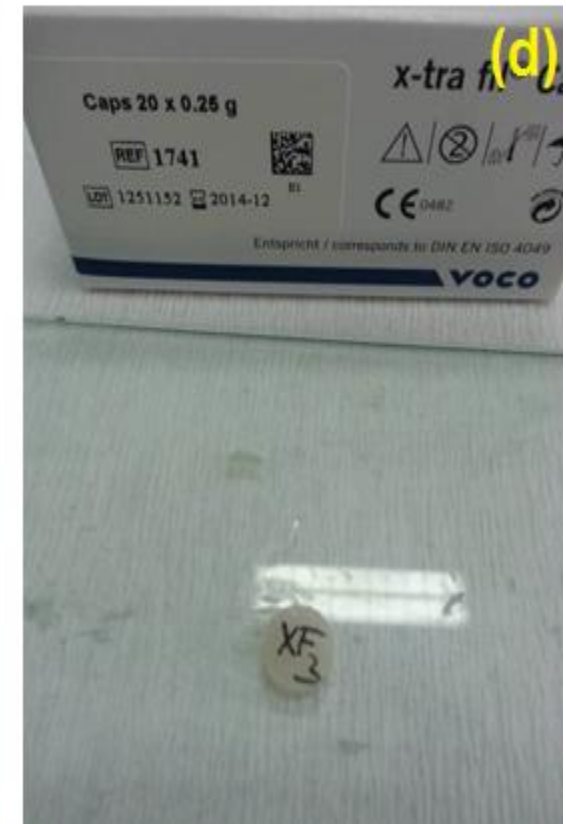
Şekil 5. 3 Dental kompozit numunelerin hazırlanması: (a) kalıba doldurma, (b) şeffaf bant uygulaması, (c) polimerizasyon, (d) polimerize olmuş dental kompozit
