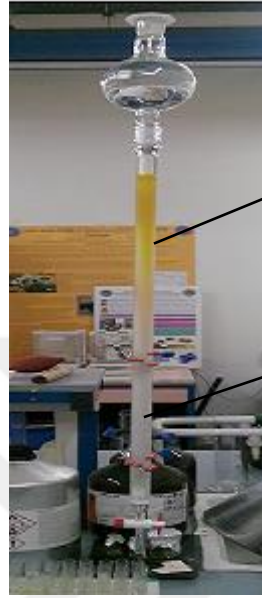
Şekil 7.4 Kolon kromatografisinde saflaştırma işlemi
