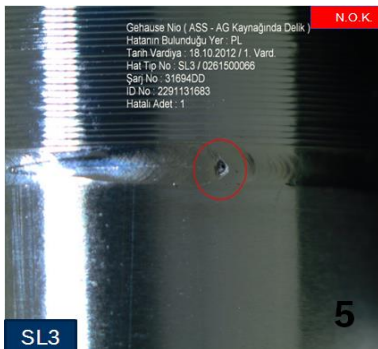
Şekil 4. 21 Kaynak dikişinde boşluk
