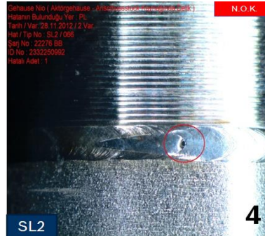
Şekil 4. 20 Kaynak dikişinde boşluk
