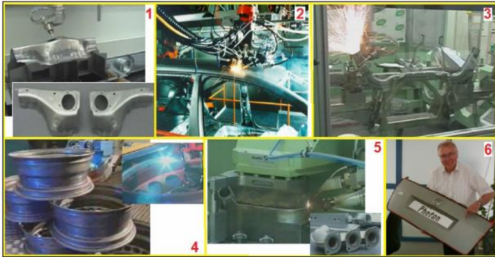
Şekil 2. 1 Otomotiv üretiminde lazer uygulamaları [19]
