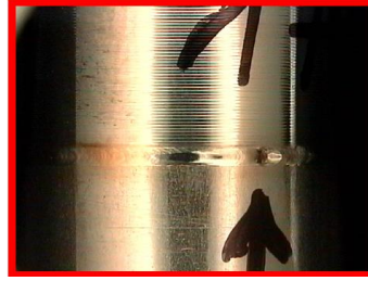
Şekil 4. 14 Kaynak dikişinde derinlik
