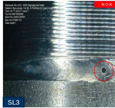
Şekil 4. 17 Kaynak dikişinde delik
