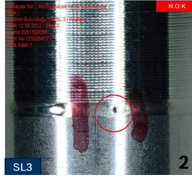
Şekil 4. 18 Kaynak dikişinde boşluk
