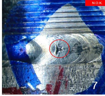
Şekil 4. 22 Kaynak dikişinde yüzey form bozukluğu ve boşluk oluşumu
