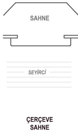
Şekil B.1 Çerçeve Sahne Plan ve Kesit örneği [95]
