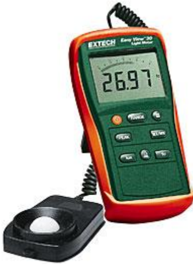
(a) Extech Wide Range Light Meter EA-30 (Aydınlık ölçer) (b) Minolta LS-110 (Isıklılık ölçer)
