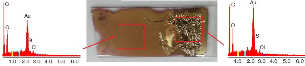
Şekil 4.21 2-Merkaptotiyokzanton ile üretilen AuNP/Polimer nanokompozit film düzgün ve bozuk yüzeylerin EDS grafikleri
