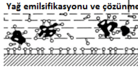
Kirin Yüzeyden Sökülmesi
