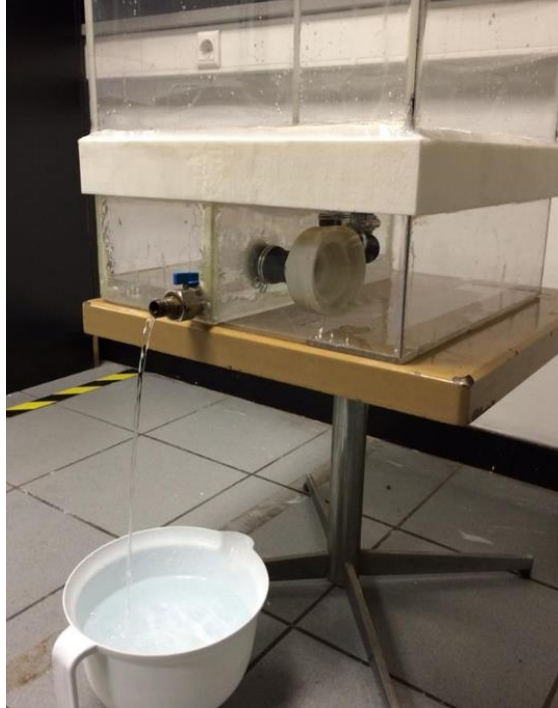
Şekil 6. 10 Pompa ve küresel vananın montajı
