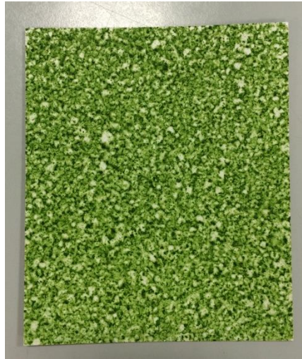
Şekil 6. 19 Deneysel çalışmalarda kullanılan standart kir plakası
