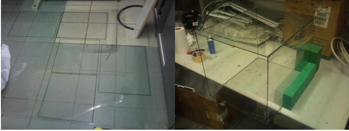
Şekil 6. 6 Malzemenin kesilmesi ve birleştirilmesi
