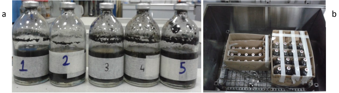
Şekil 3.16 (a) Hazırlanan BMP deney şişeleri ve (b) inkübasyon ortamı
