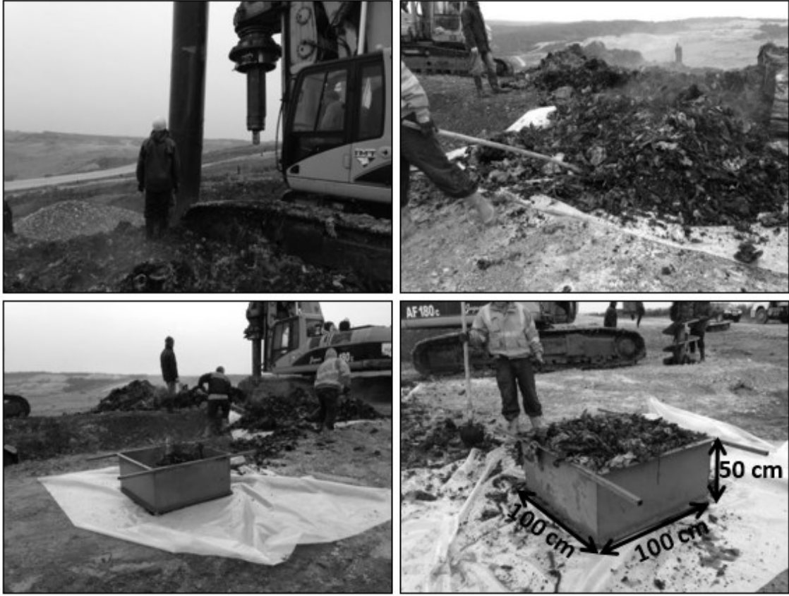
Şekil 3.9 Kuyu sondajı ve numune alımından görüntüler
