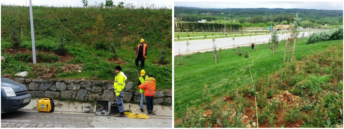
Şekil 3.19 Sahada uygulanan çoklu elektrotlu özdirenç çalışmasından görüntüler
