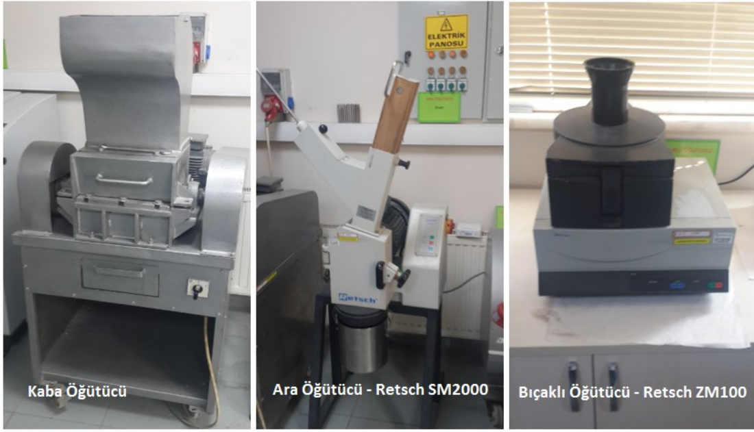
Şekil 3.13 Numune hazırlanmasında kullanılan öğütücülerin genel görünümü
