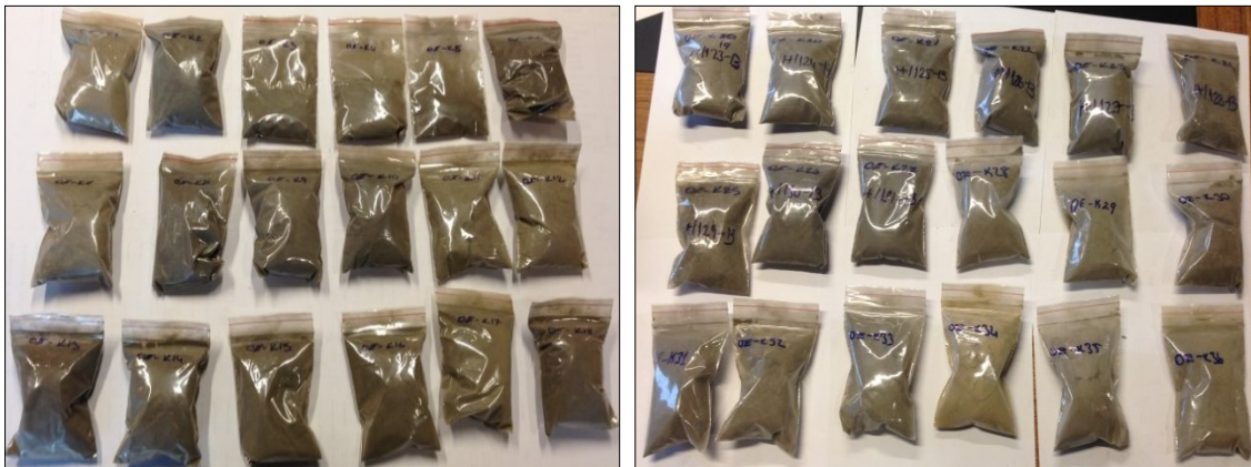
Şekil 3.14 Toz haline getirilmiş eski ve taze katı atık numuneleri
