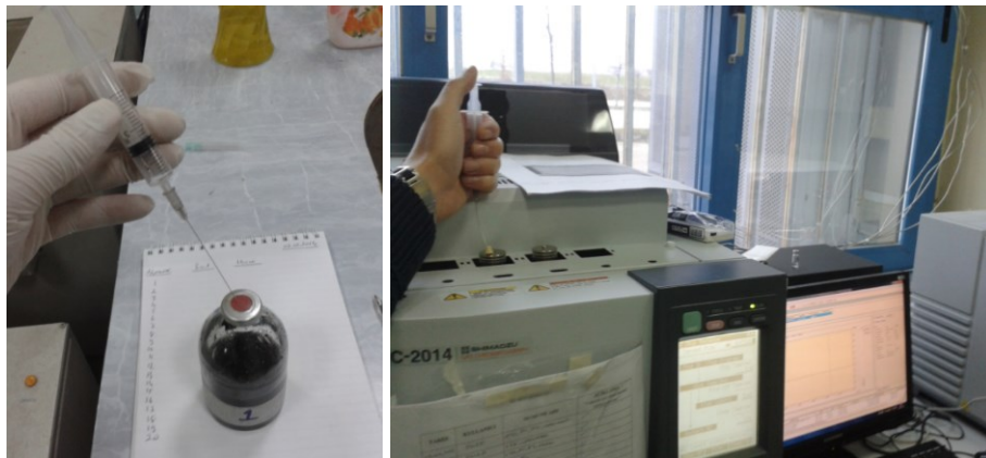
Şekil 3.17 Çalışma süresince yapılan gaz ölçümleri ve gaz bileşeni analizleri
