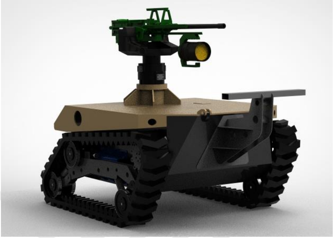
Şekil 2. 1 İnsansız Kara Aracının silah yükseltme mekanizması kapalı görünümü (Yükseklik: 1350 mm)
