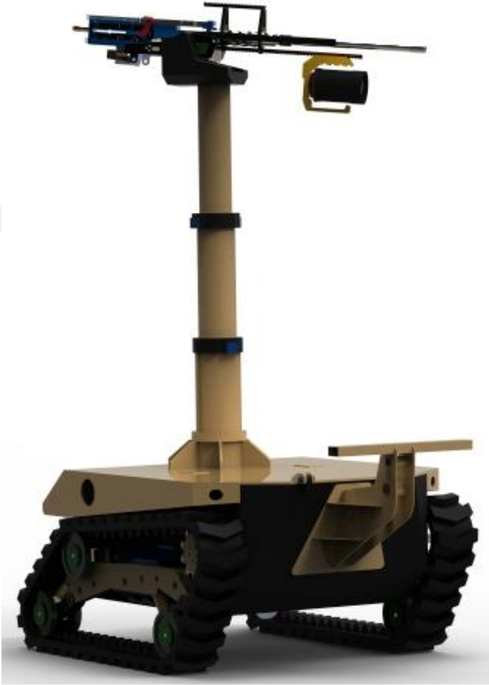
Şekil 2. 3 İnsansız Kara Aracının silah yükseltme mekanizması açık görünümü (Yükseklik: 2360 mm)
