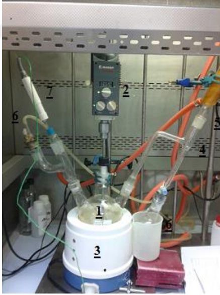
Şekil 5.11 SSO Sentezi için kullanılan reaktör düzeneği
