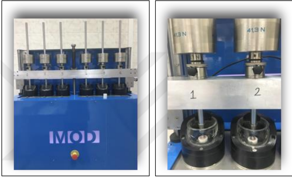
Şekil 2.12. Örneklerin çiğneme simülatöründe termo-mekanik olarak yüklenmesi
