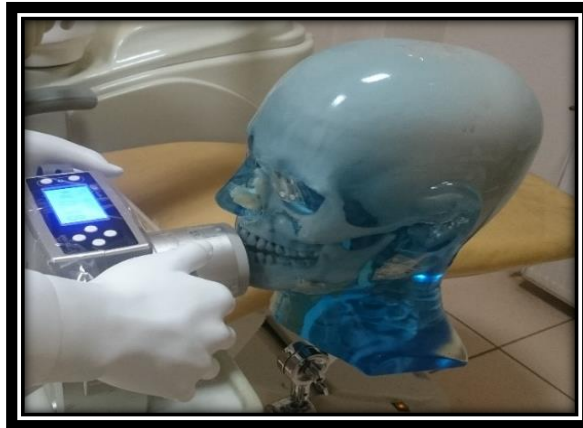
Şekil 2.12 Rezin esaslı yumuşak ve sert doku eşdeğeri fantom kafa
