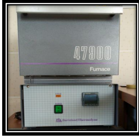
Şekil 2.5 TLD'lerin ısıtılması işleminde kullanılan fırın
