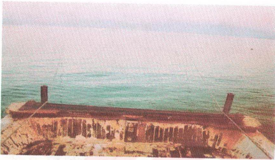
Şekil 3.11. Çekme halatlarının eşit şekilde tekneye çekilmesi.
