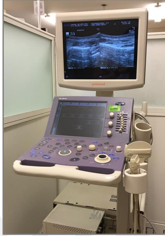
Şekil 2.10. Kasların boyutsal ölçümlerinin yapıldığı ultrason cihazı (ProSound Alpha 6; Hitachi- Aloka Medical, Tokyo, Japan)
