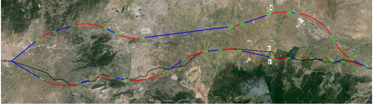
Şekil 7.9 Mevcut ve tasarlanan hatlara ait güzergah geçkileri
