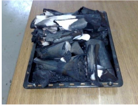
Şekil 3. 17 450 °C'de on saat dumansız yakılarak organik yapıdan arındırılan kemiklerden BHA elde edilmesi
