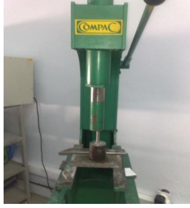
Şekil 3. 8 Hidrolik manuel pres
