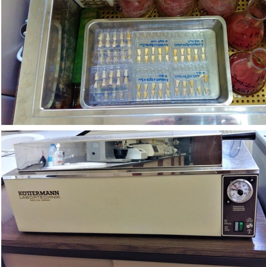
Şekil 2.10. 37° C’de ve %100 nemli etüv ortamı ve cihazı
