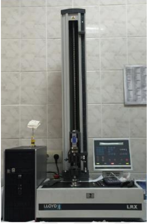
Şekil 2.16. Push-out bağlanma dayanımı testinin yapıldığı universal test cihazı
