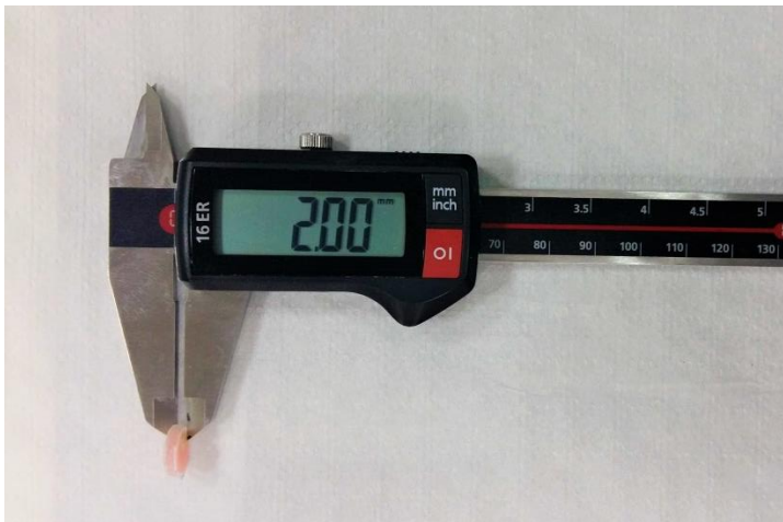
Şekil 2.14. Örneklerin kalınlıklarının dijital kumpas ile ölçülmesi
