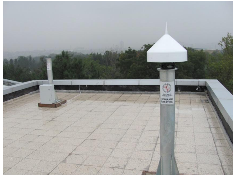
Şekil 6.1 YLDZ GNSS istasyonu
