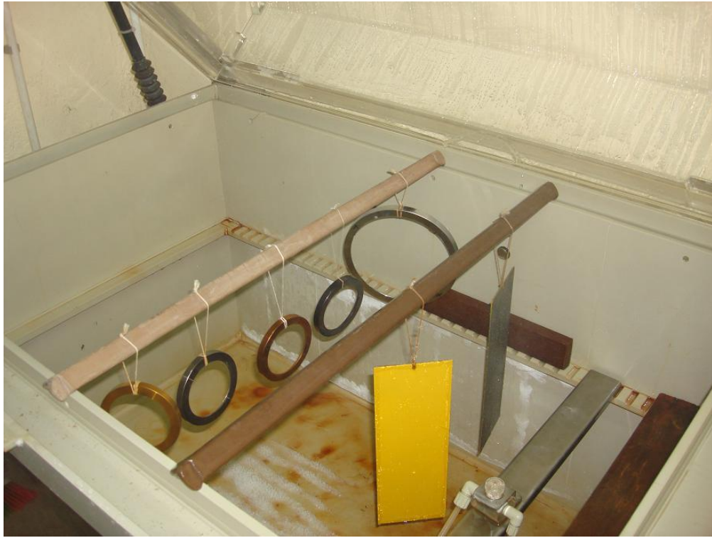
Şekil 5.4 Numunelerin tuz püskürtme cihazı içindeki yerleşimleri
