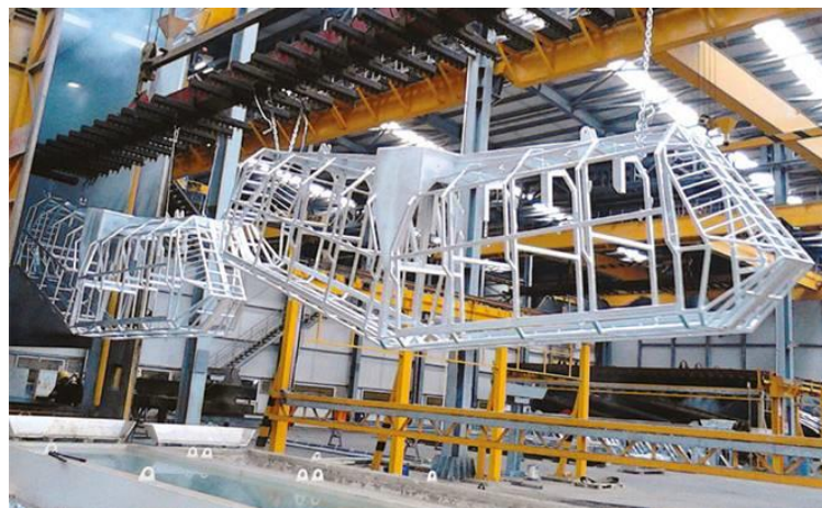
Şekil 3. 3 Sıcak daldırma galvaniz uygulaması [25]
