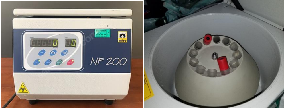
Şekil 3.5. Şantrifüj cihazı ve tüplerin cihaza yerleştirilmesi
