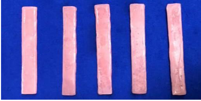
Şekil 3.4. Esneme dayanımı testi için bar şeklinde hazırlanan örnekler
