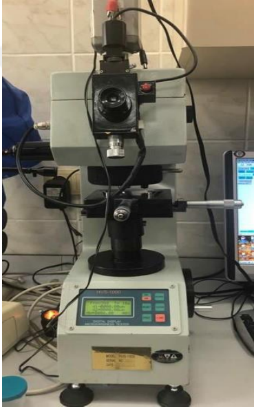
Şekil 3.7. Yüzey sertliği testi ve mikroskop altındaki görüntüsü
