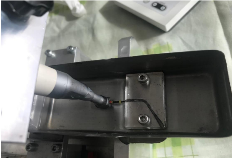
Şekil 2.4. Sodyum hipoklorit ve serum fizyolojik çözeltilerinin konulduğu test cihazı haznesi
