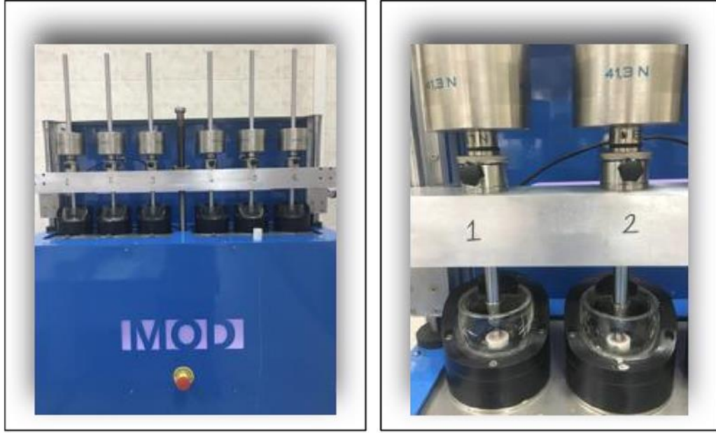
Şekil 2.5. Örneklerin çiğneme simülatöründe termo-mekanik olarak yüklenmesi
