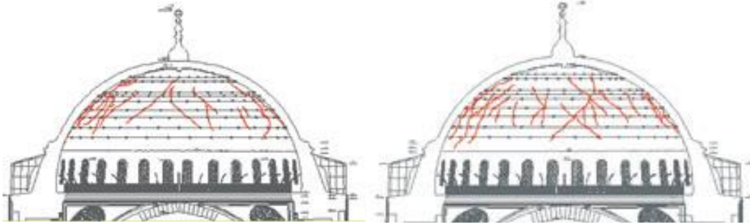
Şekil 2.7 Cami ana kubbesi kesitleri üzerindeki çatlakların gösterimi [61]
