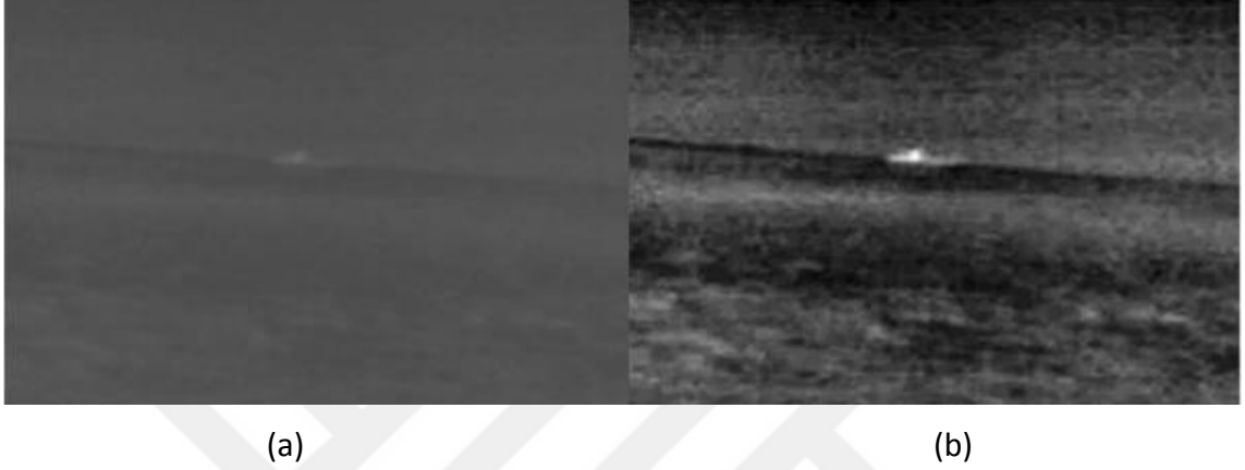
Şekil 1.9 Benzer yapılı filtre ile elde edilen kızılötesi görüntü (a) Orjinal görüntü [2] (b) Yöntem ile elde edilen görüntü
