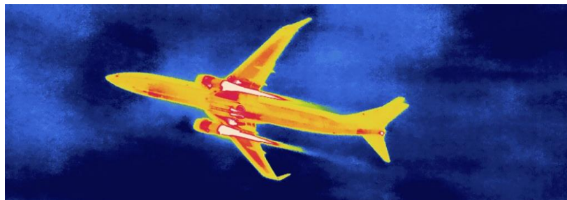
Şekil 3.7 Aerodinamik sıcaklık izi [32]
