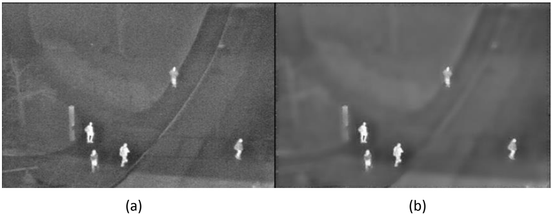
Şekil 1.8 Wiener filtresi ile elde edilen kızılötesi görüntü (a) Orjinal görüntü [8] (b) Yöntem ile elde edilen görüntü
