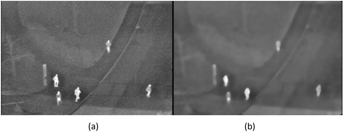
Şekil 1.4 Ortalama filtre ile elde edilen kızılötesi görüntü (a) Orijinal görüntü [8] (b) Yöntem ile elde edilen görüntü
