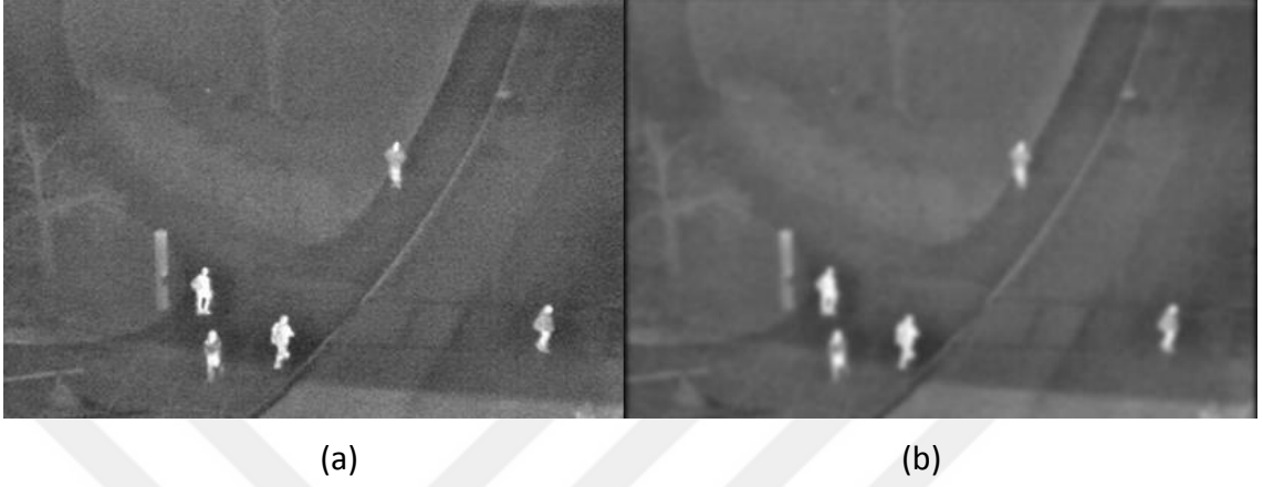
Şekil 1.5 Gaussian filtre ile elde edilen kızılotesi görüntü (a) Orjinal görüntü [8] (b) Yöntem ile elde edilen görüntü
