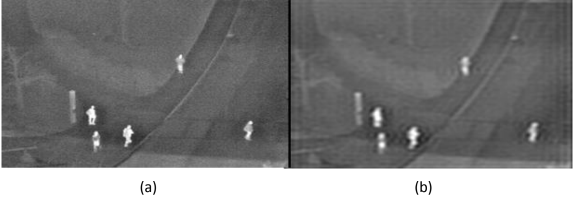
Şekil 1.14 Dairesel alçak geçiren filtre ile elde edilen kızılötesi görüntü (a) Orjinal görüntü [8] (b) Yöntem ile elde edilen görüntü
