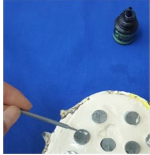
Şekil 2.6. Metal primer uygulama aşaması
