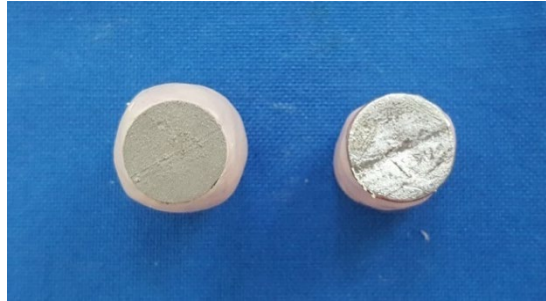
Şekil 2.3. Kumlama uygulanan ve kumlama uygulanmayan metal yüzeylerinin görüntüsü
