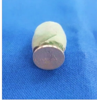
Şekil 2.2. Döküm ile elde edilen örneklerin test edilmeyecek undercut alanları c tipi silikon ile kaplanması
