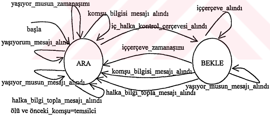
Şekil 3.4. Düğüm modülü sonlu durum diyagramı
