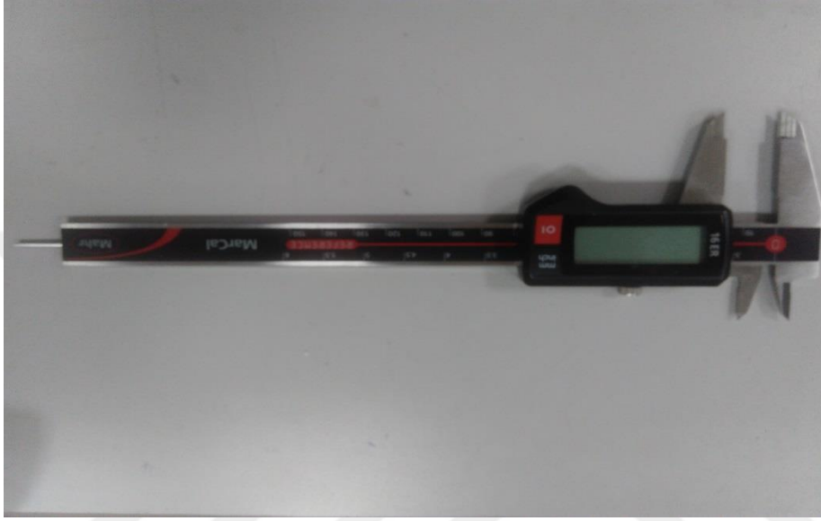
Şekil 2.12. Kırık parçaların ölçümlerinin yapıldığı dijital elektronik kumpas (MarlCal, Germany)
