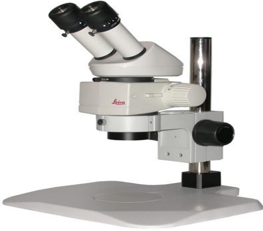
Şekil.2.2. Eğelerin kullanım öncesi incelendiği optik stereo mikroskop
