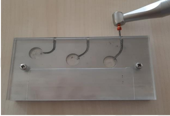
Şekil 2.6. ProTaper Universal F2 eğesi, 45° yapay kanal içinde uygulanması
