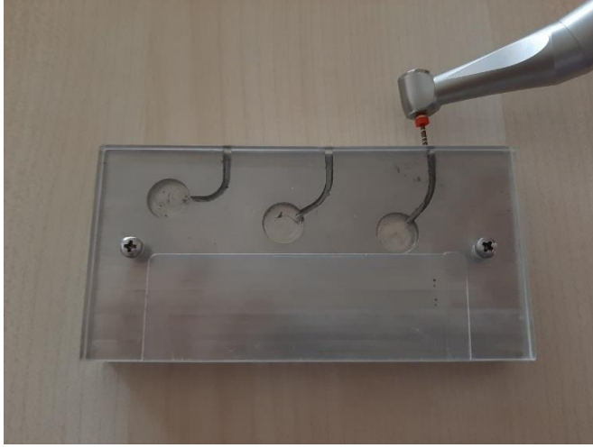
Şekil 2.9. ProTaper Gold F2 eğesi, 45° yapay kanal içinde uygulanması
