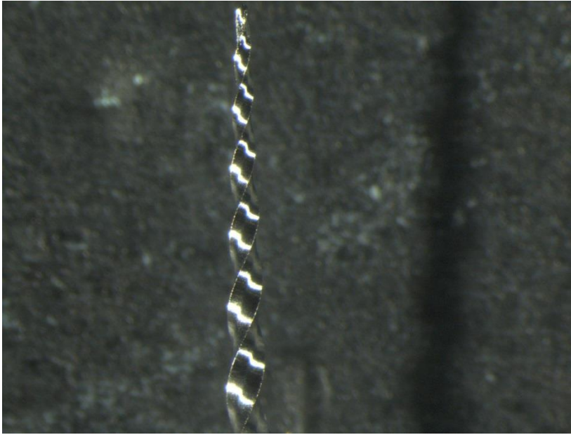
Şekil 2.3. ProTaper Universal F2 eğenin optik stereomikroskop görüntüsü (x10)
