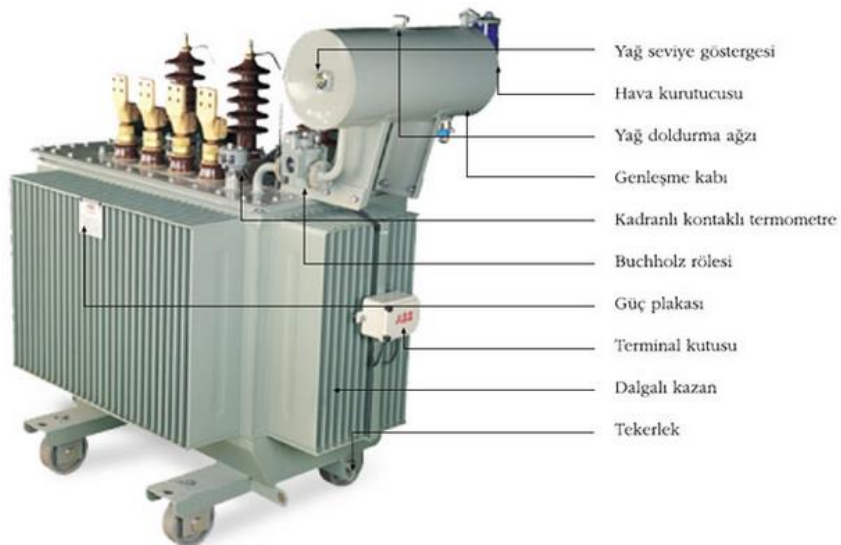
řekil 2.8 Yaęlı tip genleřme depolu transformatrn yapısı
