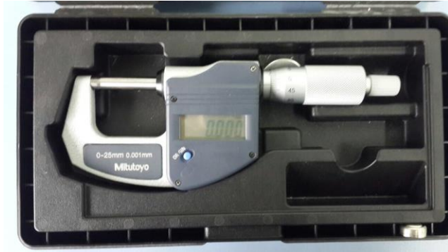
Şekil 9. 6 Kalınlık ölçümünde kullanılan mikrometre
